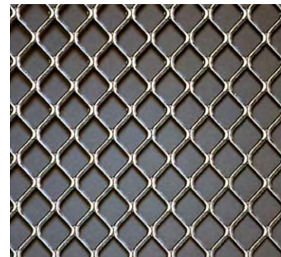
Levyverkko (expand-verkko) valmistetaan venyttämällä lävistettyä teräslevyä.
